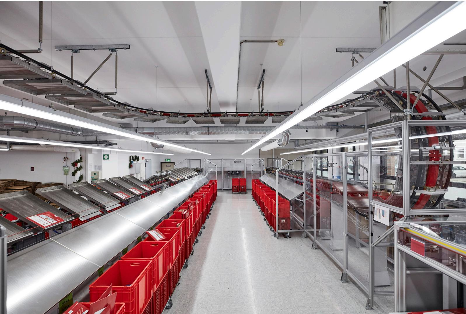
Denisort est un trieur à plateaux basculants innovant qui combine le convoyage, la préparation de commande et le tri en un seul système intégré et évolutif avec de multiples applications dans une large gamme de processus intra-logistiques. La base est une chaîne à roulements qui se déplace silencieusement dans un profilé en acier. Le système permet ainsi des solutions personnalisées avec une grande liberté d'implantation dans les trois dimensions, même sur plusieurs niveaux.
